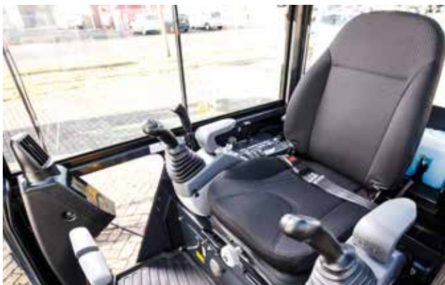
Das große rechte Fenster lässt sich nach hinten verschieben und bietet so eine hervorragende Sicht.
