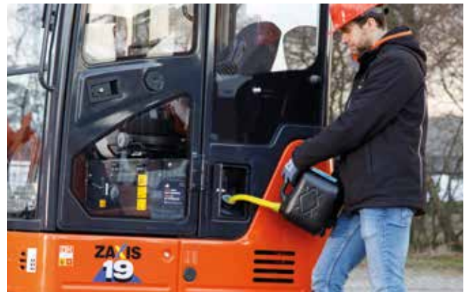
Die gut positionierte Kraftstofftanköffnung ermöglicht einfaches Auftanken.
